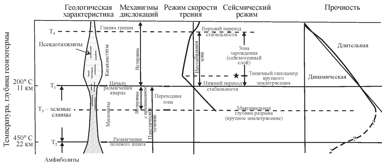
Рис. 7. Упрощенная модель сдвиговой зоны, иллюстрирующая основные геологические и сейсмологические характеристики [Scholz, 1988].
