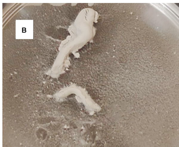
Рис. 4. Изображения цементов, где приведена микроструктура: а – КМФЦ-1, б – КМФЦ-2; фотоизображения филаментов, выдержанных в дистиллированной воде через 24 часа: в – КМФЦ-1, г – КМФЦ-2.
