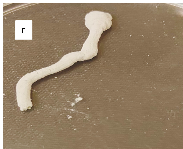
Рис. 4. Изображения цементов, где приведена микроструктура: а – КМФЦ-1, б – КМФЦ-2; фотоизображения филаментов, выдержанных в дистиллированной воде через 24 часа: в – КМФЦ-1, г – КМФЦ-2.
