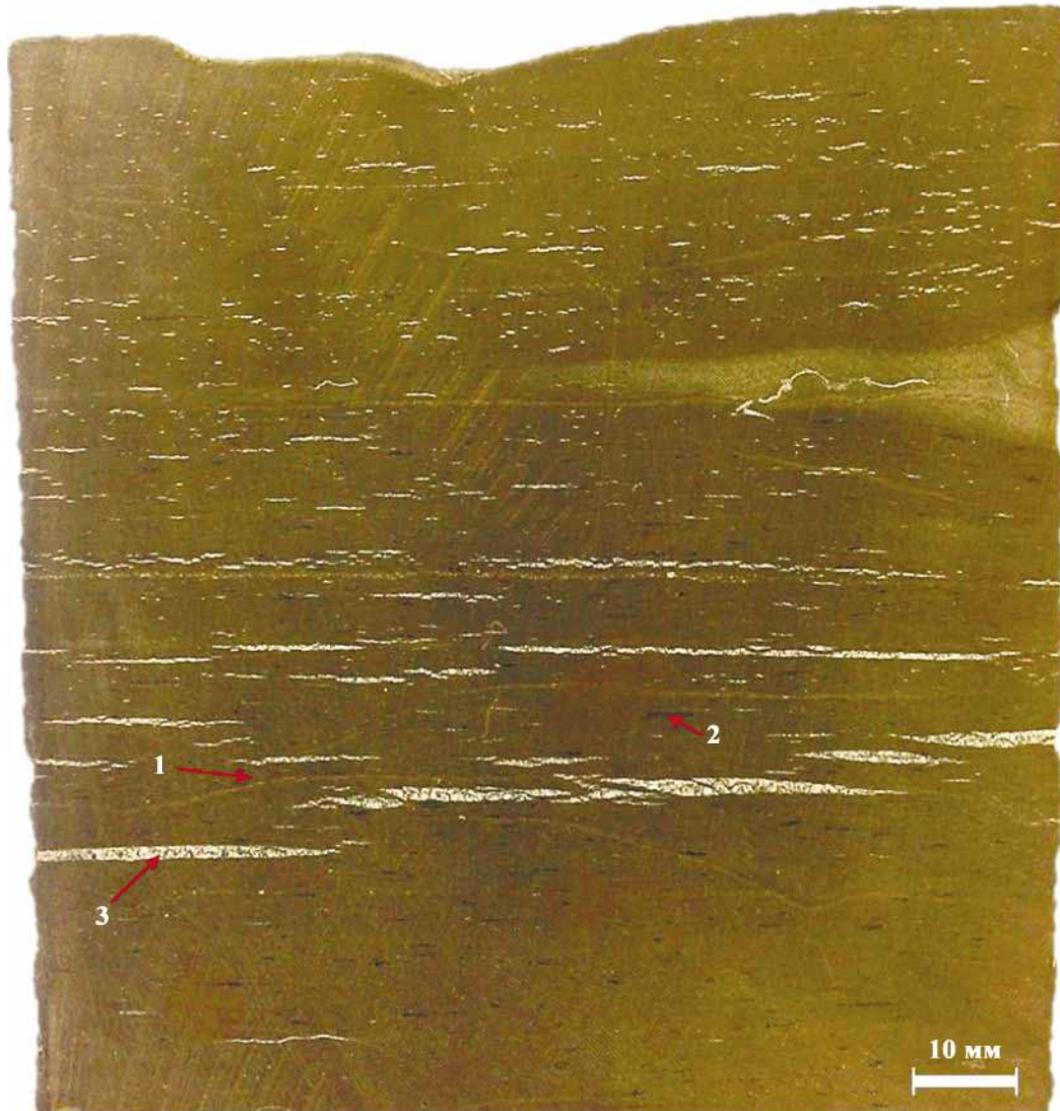
**Рис. 7.** Образец керна с тремя типами трещин.
