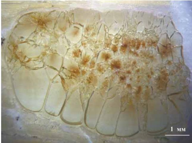
**Рис. 8.** Мелкозернистый агрегат андрадита в серпентин-карбонатной жильной массе. Полированный шлиф. Без анализатора.
