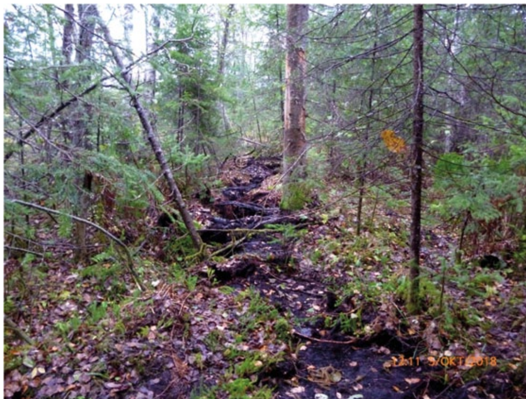
Рис. 1. Открытые протяженные трещины растяжения в левом борту оползня в 30 м от зоны отрыва. Фото А.В. Овчаренко, 2018 г.
