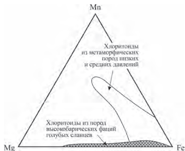
Рис. 17. Дискриминантная диаграмма хлоритоидов на основе их химического состава Mg–Mn–Fe (Chopin, Schreyer, 1983).
