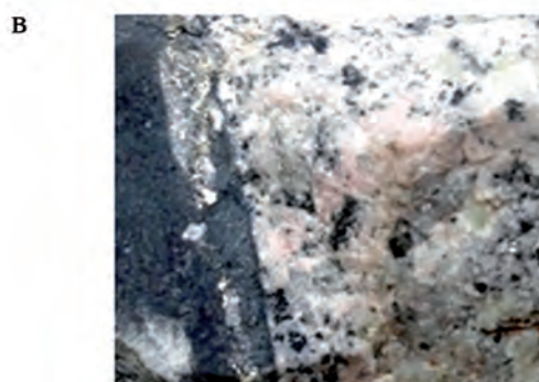
Рис. 3. Контакт гранодиорита Койташского интрузива с дайкой лампрофира (а), ясно выраженная зона калишпатизации (б) и формирование сульфидного прожилка (в).
