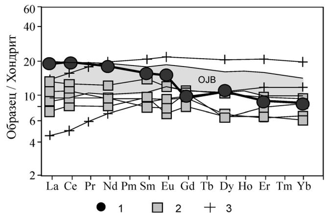
Рис. 4. Распределение редкоземельных элементов в расплавных включениях.
