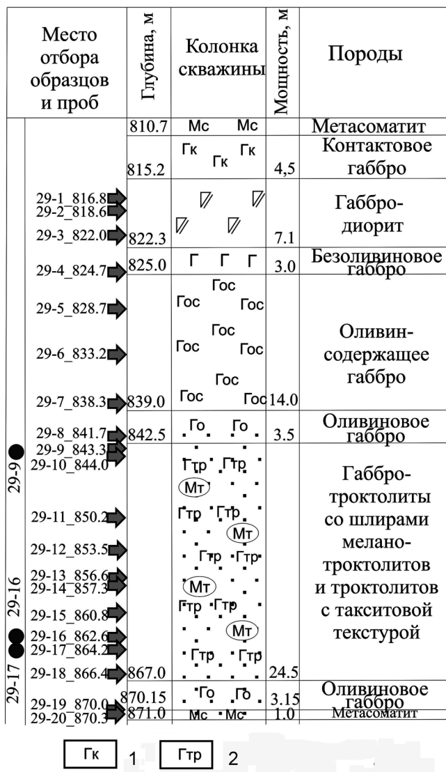
Рис. 3. Схема отбора образцов и минералогических проб по разрезу Вологочанского интрузива (скв. ОВ-29).
