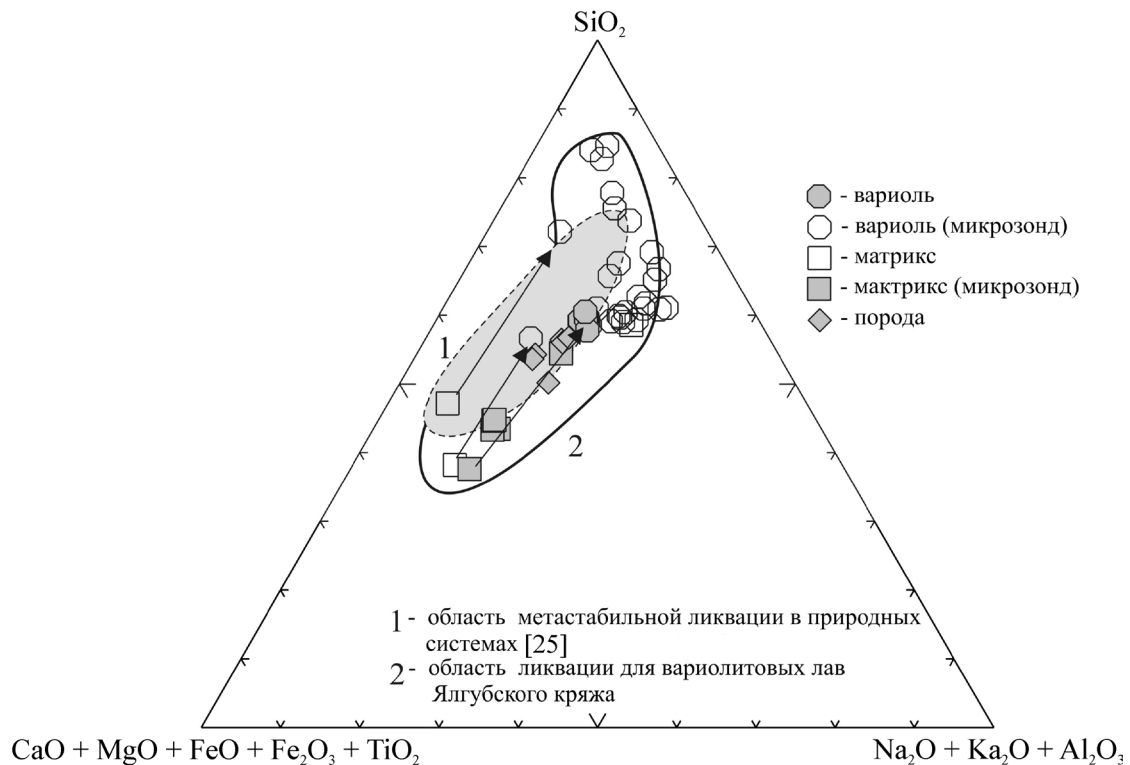
Рис. 7. Псевдотройная диаграмма в координатах \text{SiO}_2 – (\text{Na}_2\text{O} + \text{K}_2\text{O} + \text{Al}_2\text{O}_3) – (\text{CaO} + \text{MgO} + \text{FeO} + \text{TiO}_2) с областью метастабильной ликвации.
