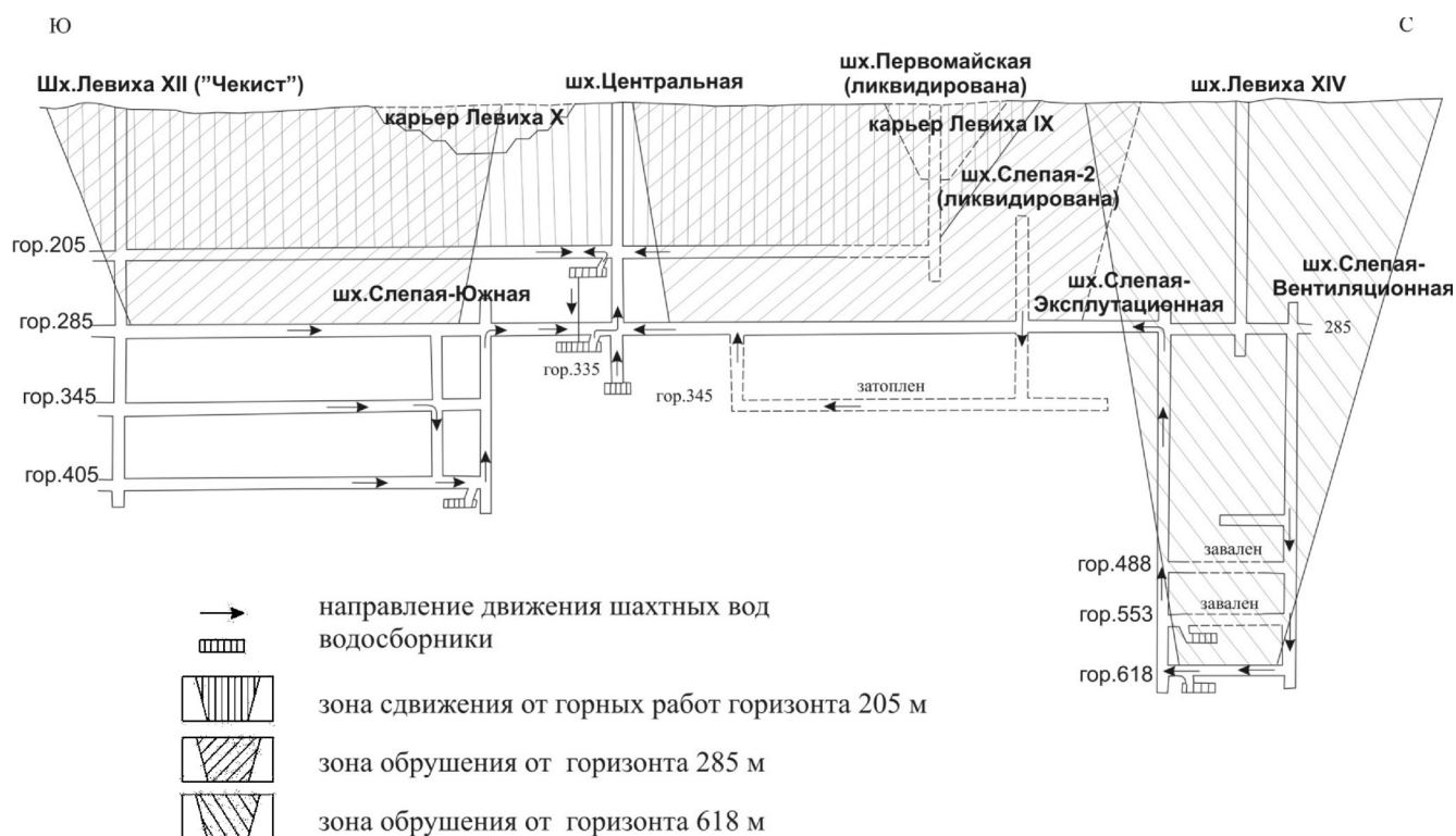
Рис. 3. Формирование зон обрушения и сдвижения горных пород на Левихинском медноколчеданном руднике (по данным института УНИПРОМЕДЬ).
