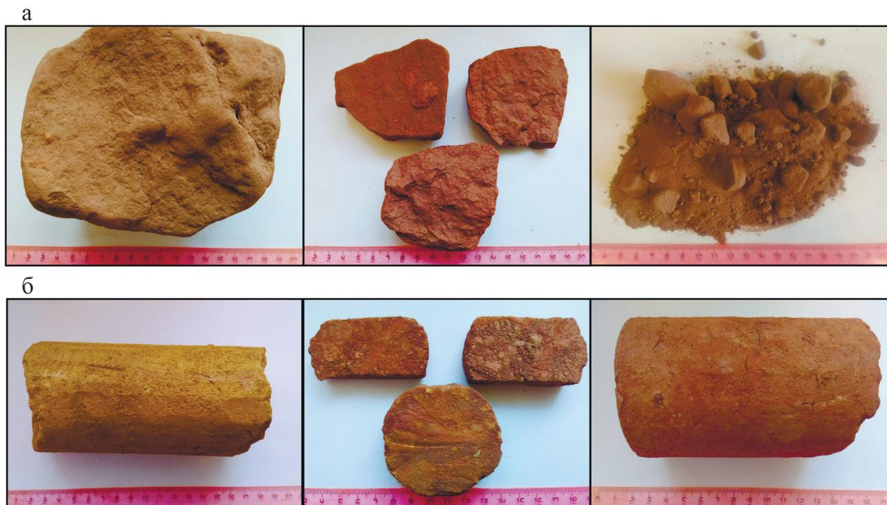
**Рис. 2.** Фотографии представительных образцов песчаников из кратерных частей кимберлитовой трубки им. В. Гриба (а) и магматического объекта KL-01 (б).
