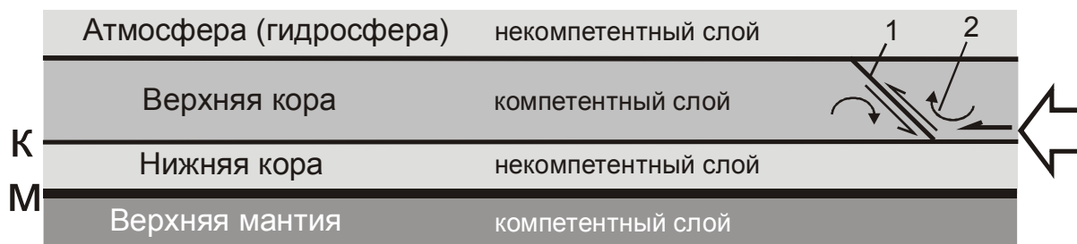
Рис. 1. Условия возникновения общекоровой складчатости 1 — надвиг; 2 — изгибающие моменты. Пояснения в тексте.
